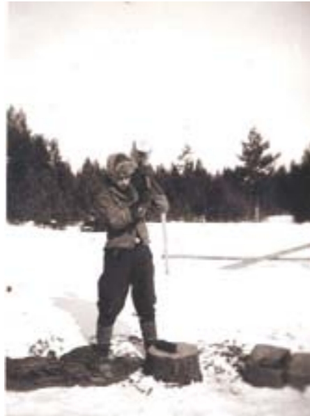
Kuvassa veljeni Mauno lyämässä aihiota. Tuppi lyötiin aluksi nahkavuodasta muotoraudalla ja puunuijalla tasaista pölkkyä vasten. Sen jälkeen oli liimaus, ompelu, lestitys, koristelu ja kantimen kiinnitys. Tuppi oli valmis vasta kymmenien työvaiheiden jälkeen.
